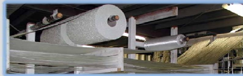
*Le resine poliestere,* trovano un'ottima applicazione in unione alle fibre di vetro; le poliestere sono caratterizzate da un basso costo, da un breve tempo di polimerizzazione e da buone caratteristiche meccaniche.
